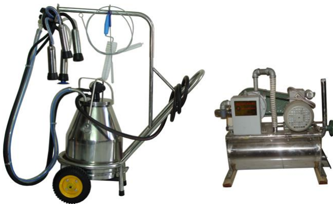
Sử dụng máy vắt sữa và thiết bị rửa máy vắt sữa chuyên dùng
