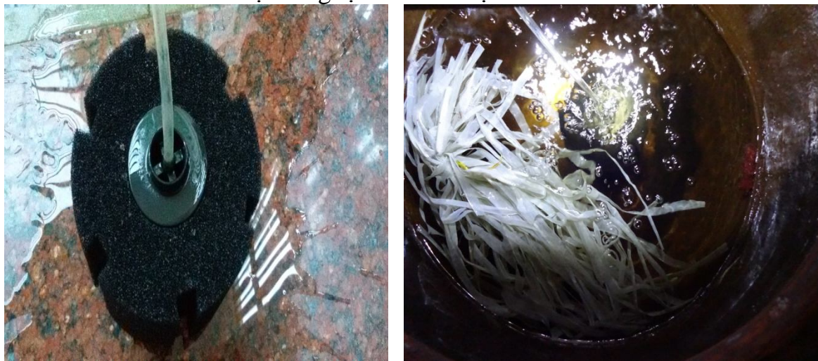
Hình 6: Một trong các thiết bị vừa lọc nước vừa sục khí trong bể nhỏ
